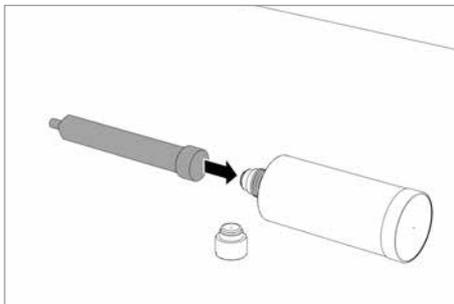
8. Verschlussdeckel der Harzkartusche (Tangit M 3000, 80 ml) abschrauben und Kartusche in den Statikmischer einschrauben.
