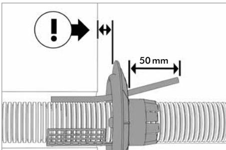
5. Quadro-Sicura® Quick/C von der Gebäudeaußenseite in die Kernbohrung schieben.
