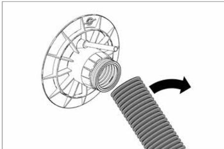
11. Wellrohr ablängen. Es verbleibt ein Wellrohrüberstand von 1-2 Wellenbergen.
