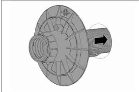
3. Innenabdichtung mit montiertem Wellrohr von der Gebäudeinnenseite in die Kernbohrung einschieben, bis die Innenabdichtung an der Wand anliegt.
