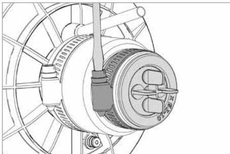
16. Nach Leitungseinzug die Schlauchschelle verspannen (max. Anzugsmoment 2 Nm).
