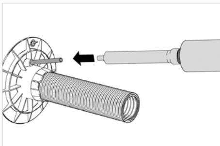
9. Statikmischer bis zum Anschlag mit dem Füllrohr fest verbinden.
