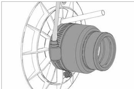
12. Endstopfen bis auf Anschlag auf den Stutzen der Außenabdichtung aufschieben. Schlauchschelle mit max. 2 Nm verspannen.
