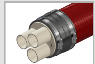
Systemdeckel D3 Mit drei Stutzen zur Abdichtung von bis zu drei Kabeln mittels Schrumpf- technik D3/59: Drei Stutzen mit \varnothing 59 mm für Kabel mit \varnothing 22 – 57 mm; Erhältlich für KSS150 und KSS125 D3/46: Drei Stutzen mit \varnothing 46 mm für Kabel mit \varnothing 16 – 44 mm; Erhältlich für KSS110 D3/30: Drei Stutzen mit \varnothing 30 mm für Kabel mit \varnothing 7 – 28 mm; Erhältlich für KSS80
