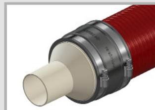
Systemdeckel D1 Mit einem Stutzen zur Abdichtung eines Kabels mittels Schrumpftechnik D1/110: Stutzen mit \varnothing 110 mm für Kabel mit \varnothing 34 – 108 mm; Erhältlich für KSS150, KSS125 und KSS110
