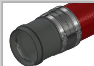
Steckmuffe SM110 oder SM160 Zum Anschluss eines glattwandigen Rohres SM110: für Rohr mit \varnothing a 110 mm; Erhältlich für KSS110 SM 160: für Rohr mit \varnothing a 160 mm; Erhältlich für KSS150
