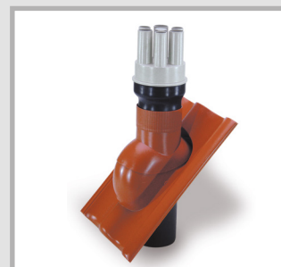
MSD110 mit sieben Stutzen und sechs Thermo-Schrumpfmuffen Ein Stutzen ist im Lieferzustand geschlossen und kann bei Bedarf durchbrochen werden; Geeignet für maximal vier Kabel mit Durchmesser 7 – 23 mm und maximal drei Kabel mit Durchmesser 7 – 30 mm; Als Zubehör sind verschiedene Aufteilkappen AK oder Verschluss-Stopfen VS25 bzw. VS32 lieferbar Produktname: MSD110/D7/32/25
