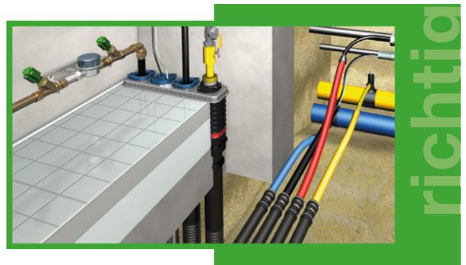
► Die sichere Ausführung einer Mehrsparten-Hauseinführung am Bsp. der Quadra Secura® Basic R4+
