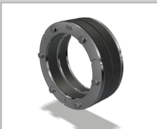
Ring-Raum-Dichtung RRD-WR1 aus EPDM-Gummi, 40 mm gegen nicht drückendes Wasser, in geteilter Ausführung und integriertem Stützring, Metallteile aus A2-Edelstahl
