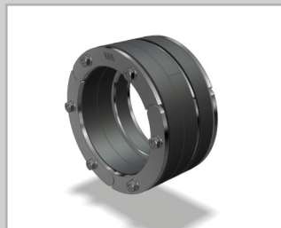
Ring-Raum-Dichtung RRD-WR2 aus EPDM-Gummi, 60 mm gegen drückendes Wasser, in geteilter Ausführung und integriertem Stützring, Metallteile aus A2-Edelstahl
