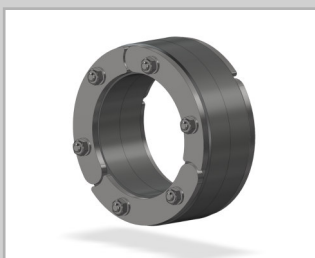
Ring-Raum-Dichtung RRD2 aus EPDM-Gummi, 40 mm gegen drückendes Wasser, Metallteile aus A2-Edelstahl
