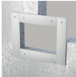
Bild 2: Aufleistung für Massivwand und leichte Trennwand (wahlweise ein- oder beidseitig angeordnet, Dicke der Aufleistung je Seite max. 50 mm)
