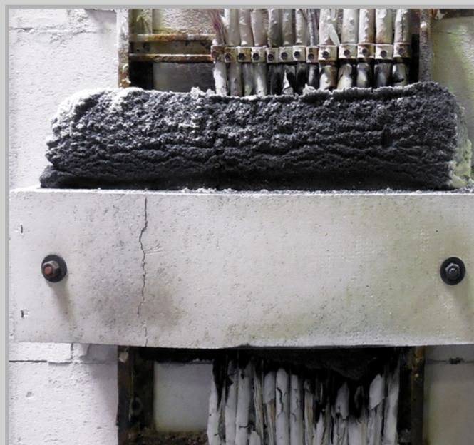
**Abb. 3:** ZZ W20 nach der 90-minütigen Brandbeanspruchung nach Einheitstemperaturkurve (ETK)
